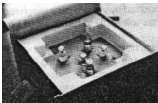
Figure 3-R : Utilisation du coussinet en mousse
