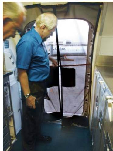
Contrôle d'une moustiquaire à bord d'un avion
