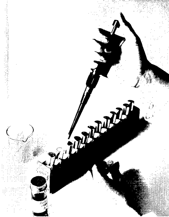
Fig. 3 Préparation de dilutions de sérum de deux en deux à l'aide d'une pipette automatique munie d'embouts stériles jetables
